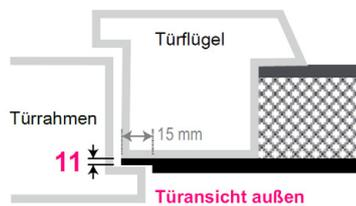
**11** Mindestens 1 mm + Aufbaustärke des Klebesystems. Die Breite der Abfällung beträgt generell 15 mm.
